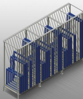
Regal für die Lagerung von Fensterelementen. Stabile Stahlkonstruktion. Vertikales Flügelpufferregal zum Einsortieren der Flügelemente. Pufferregal mit zehn Fächern. Schneller Zugriff zu den Elementen. Kunststoffüberzogene Fachteilrohre. Anlagefläche mit Kunststoffplatte. Spezielle Gleitblech-Auflage ermöglicht eine ergonomische Entnahme der Flügelemente nach Bedarf.
