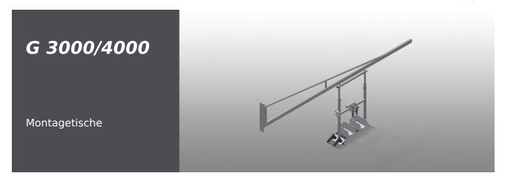
Gerätehalter für Druckluft- und Elektrogeräte. Befestigung an der Wand oder Stahlsäule. Bewegliche Ablagevorrichtung für Werkzeuge und Druckluftgeräte, dadurch bessere Arbeitsbedingungen. Keine Luftschläuche auf dem Boden. Werkzeughalter mit Höhenverstellung. Serienmäßig mit zwei Spiralschläuchen (ohne Werkzeuge). Mit Wartungseinheit und Luftanschluss-Schlauch. Schuko-Steckdosen 2-fach. Druckluftanschluss 4-fach.
