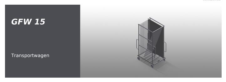
Stabile Stahlkonstruktion. Ideal zur Glassortierung. Für den innerbetrieblichen Transport von Glasscheiben. Fachteiler für 15 Glasscheiben. Zugriff von beiden Seiten möglich. Die Glasaufstellfläche ist mit Gummiprofil belegt. Fachteiler mit Kunststoffschutz. Transportbügel beidseitig zum Verfahren. Zwei Lenkrollen und zwei Bockrollen.
