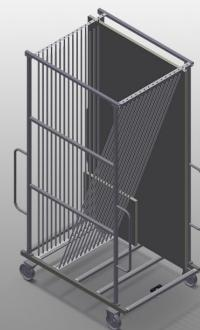
Stabile Stahlkonstruktion. Ideal zur Glassortierung. Für den innerbetrieblichen Transport von Glasscheiben. Fachteiler für 15 Glasscheiben. Zugriff von beiden Seiten möglich. Die Glasauflstellfläche ist mit Gummiprofil belegt. Fachteiler mit Kunststoffschutz. Transportbügel beidseitig zum Verfahren. Zwei Lenkrollen und zwei Bockrollen.
