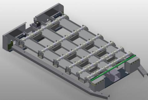
Einfaches Handling von Glasscheiben in Kombination mit Glasfachwagen GFW 15. Mit pneumatischer Hubeinrichtung, steuerbar über Fußventil, max. Hub = 50 mm. Untere Rollengänge ausgestattet mit insgesamt 15 x 4 PVC-Rollen. Komplett mit Einfahrhilfe für Glasfachwagen GFW 15. Grundmaße: 2.100 x 1.250 mm.
