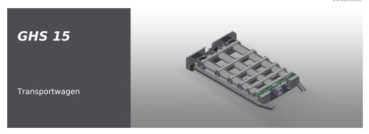
Einfaches Handling von Glasscheiben in Kombination mit Glasfachwagen GFW 15. Mit pneumatischer Hubeinrichtung, steuerbar über Fußventil, max. Hub = 50 mm. Untere Rollengänge ausgestattet mit insgesamt  $15 \times 4$  PVC-Rollen. Komplett mit Einfahrhilfe für Glasfachwagen GFW 15. Grundmaße:  $2.100 \times 1.250$  mm.
