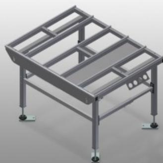
Horizontaler Tisch für alle Arbeiten an Rahmen und Flügeln. Stabile Stahlkonstruktion. Tischauflage mit Kunststoff-Gleitleisten. Ablageboden zum Ablegen von Werkzeug und Zubehör. In der Höhe justierbar. Einfache Montage im Baukastensystem.
