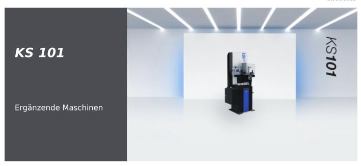
Präzise Klinksäge für V-Schnitte 90° in Kunststoffprofile. Die Maschine verfügt über 2 vertikale pneumatische Spanneinrichtungen. Die Verstellung der Schnitttiefe in Y-Achse erfolgt stufenlos über Handrad. Der pneumatische Säge-Vorschub kann stufenlos eingestellt werden, der Rückhub erfolgt im Eilgang. Serienmäßig ist die Maschine mit Abfall-/Spänebehälter, Sägeblätter und Anschluss für Späneabsaugschlauch ausgestattet.
