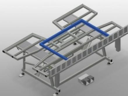
Montagetisch für vertikale und horizontale Montage. Stabile Stahlkonstruktion. Wichtig beim Wechsel vom vertikalen zum horizontalen Transport und umgekehrt. Ideal für vertikale und horizontale Montage. Pneumatisch kippbar. Tischauflage mit Kunststoff-Gleitleisten. Rollenauflage pneumatisch absenkbar. Druckluftanschluss 4-fach.
