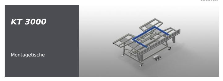
Montagetisch für vertikale und horizontale Montage. Stabile Stahlkonstruktion. Wichtig beim Wechsel vom vertikalen zum horizontalen Transport und umgekehrt. Ideal für vertikale und horizontale Montage. Pneumatisch kippbar. Tischauflage mit Kunststoff-Gleitleisten. Rollenauflage pneumatisch absenkbar. Druckluftanschluss 4-fach.
