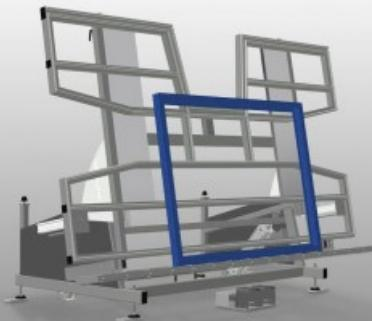
Montagetisch für vertikale und horizontale Montage. Stabile Stahlkonstruktion. Wichtig beim Wechsel vom vertikalen zum horizontalen Transport und umgekehrt. Ideal für vertikale und horizontale Montage. Stufenlose Zwischenstellungen für ergonomisches Arbeiten. Pneumatisch kippbar. Senkrecht pneumatisch höhenverstellbar. Tischauflage mit Kunststoff-Gleitleisten. Rollenauflage pneumatisch absenkbar. Zwei seitliche, pneumatische Spanner (absenkbar). Druckluftanschluss 4-fach.
