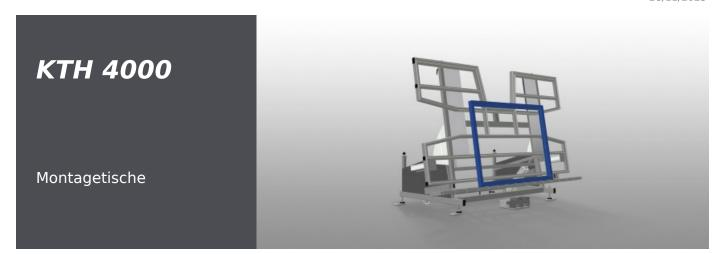
Montagetisch für vertikale und horizontale Montage. Stabile Stahlkonstruktion. Wichtig beim Wechsel vom vertikalen zum horizontalen Transport und umgekehrt. Ideal für vertikale und horizontale Montage. Stufenlose Zwischenstellungen für ergonomisches Arbeiten. Pneumatisch kippbar. Senkrecht pneumatisch höhenverstellbar. Tischauflage mit Kunststoff-Gleitleisten. Rollenauflage pneumatisch absenkbar. Zwei seitliche, pneumatische Spanner (absenkbar). Druckluftanschluss 4-fach.
