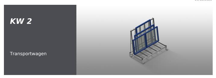
Kommissionswagen für innerbetrieblichen- und LKW-Transport der Fensterelemente. Stabile Stahlkonstruktion. Wagen für inner- und außerbetrieblichen Transport. Aufnahme für Staplertransport. Vier Haken für Krantransport. Vier Zurrgurthalter. Profilauflage mit Gummibelag. Lenkrollen abnehmbar, dadurch sicherer Stand des Kommissionswagens auf dem LKW. Vier Lenkrollen, davon zwei mit Feststellbremse.
