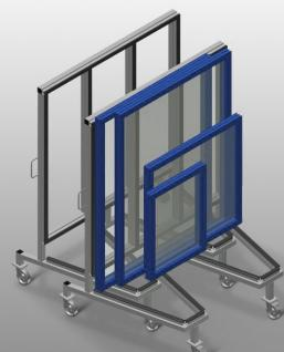
Kommissionswagen für innerbetrieblichen Transport der Fensterelemente. Stabile Stahlkonstruktion. Für innerbetriebliche Transporte. Profilauflage mit Gummibelag. Im unbeladenen Zustand ineinander verschiebbar, dadurch geringerer Platzbedarf. Vier Lenkrollen, davon zwei mit Feststellbremse.
