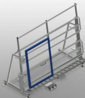
Montagetisch für vertikale Montage. Stabile Stahlkonstruktion. Ideal für vertikale Montage. Geeignet für Linien. Stufenlose Zwischenstellungen für ergonomisches Arbeiten. Höhenverstellung mit Pneumatikzylinder. Rollenaufgabe mit Stahlrollen. Tischaufgabe mit Kunststoff-Gleitleisten. Zwei horizontal verschiebbare Profilspanner. Druckluftanschluss 4-fach.
