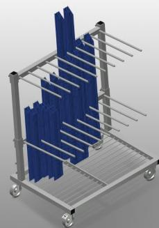
Profilwagen für die senkrechte Lagerung und den Transport von Profilen. Stabile Stahlkonstruktion. Senkrechter Profiltransport. Einseitig zu beladender Profilwagen. Einfaches Be- und Entladen. Ausreichend für 30 – 40 Profilstäbe. Fachteiler in der Höhe verstellbar. Aufstellfläche als Stab rasterboden. Vier Lenkrollen, davon zwei mit Feststellbremse.
