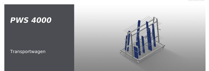
Profilwagen für die senkrechte Lagerung und den Transport von Profilen. Stabile Stahlkonstruktion. Senkrechter Profiltransport. Doppelseitig zu beladender Profilwagen. 18 Fächer pro Seite. Einfaches Be- und Entladen. Ausreichend für 120 – 160 Profilstäbe. Fachteiler höhenverstellbar. Aufstellfläche als Stabrasterboden. Vier Lenkrollen, davon zwei mit Feststellbremse.
