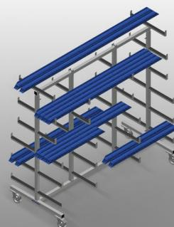
Profilwagen für die waagrechte Lagerung und den Transport von Profilen. Stabile Stahlkonstruktion. Waagrechter Profiltransport. Auflagearme gummibeschichtet. Profilwagen mit doppelseitigen Profilablagen. Sechs Ablagen pro Stütze. Zwei Mittelstützen. Vier Lenkrollen, davon zwei mit Feststellbremse.
