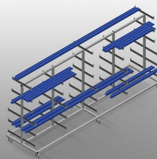
Profilwagen für die waagrechte Lagerung und den Transport von Profilen. Stabile Stahlkonstruktion. Waagrechter Profiltransport. Leichter Transport für Stabmaterial und Profilzuschnitte. Auflagearme gummibeschichtet. Profilwagen mit doppelseitigen Profilablagen. Sechs Ablagen pro Stütze. Drei Mittelstützen. Sechs Lenkketten, davon zwei mit Feststellbremse.
