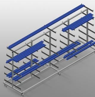
Profilwagen für die waagrechte Lagerung und den Transport von Profilen. Stabile Stahlkonstruktion. Waagrechter Profiltransport. Leichter Transport für Stabmaterial und Profilzuschnitte. Auflagearme gummibeschichtet. Profilwagen mit doppelseitigen Profilablagen. Sechs Ablagen pro Stütze. Drei Mittelstützen. Sechs Lenkrollen, davon zwei mit Feststellbremse.
