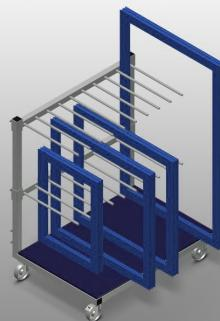
Profilwagen für innerbetrieblichen Transport von Rahmen und Flügeln. Stabile Stahlkonstruktion. Wagen mit Sortierkamm zum Transport und zur Lagerung von Rahmen und Flügeln. Hartholzauflage. Fachteiler für neun Rahmen. Fachteiler in der Höhe verstellbar. Vier Lenkrollen, davon zwei mit Feststellbremse.
