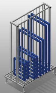
Regal für die Lagerung von Rahmenelementen. Stabile Stahlkonstruktion. Regal für die Lagerung von Rahmen. Die Elemente stehen einzeln direkt zu Verfügung. Speziell für die Integrierung in Montagelinien entwickelt. Zugriff von beiden Seiten möglich. Bodenauflage mit Pilzprofil belegt. Fachtrennstäbe mit Schutzschlauch bezogen.
