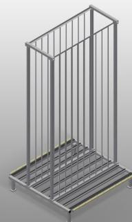
Regal für die Lagerung von Rahmenelementen. Stabile Stahlkonstruktion. Regal für die Lagerung von Rahmen. Die Elemente stehen einzeln direkt zu Verfügung. Speziell für die Integrierung in Montagelinien entwickelt. Zugriff von beiden Seiten möglich. Bodenauflage mit Pilzprofil belegt. Fachtrennstäbe mit Schutzschlauch bezogen. Aufstellfläche mit Rollen für noch einfacheres Be- und Entladen.
