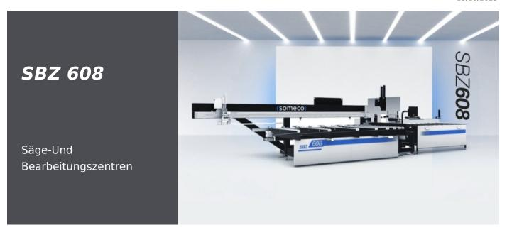
Schnelles Nachfolgezentrum für Armierungsverschraubung, Bohren und Fräsen von Profilzuschnitten für den Fenster-, Türen- und Fassadenbau mit und ohne Stahlarmierung. Ausgeführt in portalbauweise für hohe Profilquerschnitte und prozessoptimierten Durchlauf.
