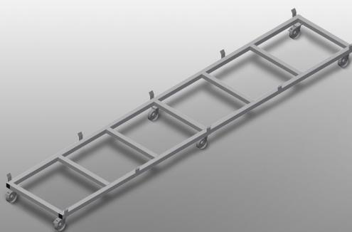
Stabile Stahlkonstruktion. Transportwagen zur Beförderung von Profilkassetten. Ideal für den Transport der Profilkassetten vom Lager bis zur Säge oder zum Bearbeitungszentrum. Für Profilpaletten bis 760 mm Breite. Sicherungslaschen zur Palettensicherung. Sechs Rollen, vier Lenkrollen mit Feststellbremse und zwei Bockrollen.
