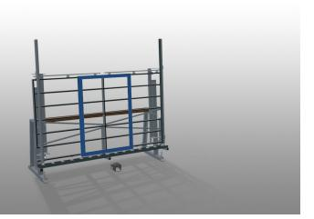
Kontroll- und Verglasungseinheit für das Verglasen und die Endkontrolle. Schnelle, exakte Fenster-, Türen- und Elementenmontage. Stabile Stahlkonstruktion. Genauigkeit durch parallele Spannbalkenpressung mit manuell abschwenkbaren Pressbalken. Einfache Handhabung durch Fußschalter. Pneumatische Mittenzentrierung, ablage für Werkzeug und Druckluftanschluss 4-fach.
