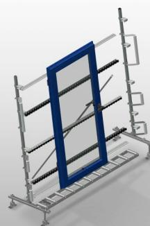
Rollenbahn vertikal für Transport und Lagerung von Fensterelementen. Stabile Stahlkonstruktion. Erweiterung im Baukastensystem. Vertikale Rollenbahn für fließenden Transport und Lagerung von Fensterelementen. Einfaches Handling von Fensterelementen. Jede Rollenbahneinheit 2.000 mm lang. Kunststoff-Gleitleisten oben und unten. Drei Röllchenbahnen mit Gummi-Rollen, Durchmesser 50 mm. Grundeinheit ohne Endständer.
