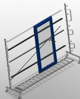
Rollenbahn vertikal für Transport und Lagerung von Fensterelementen. Stabile Stahlkonstruktion. Erweiterung im Baukastensystem. Vertikale Rollenbahn für fließenden Transport und Lagerung von Fensterelementen. Einfaches Handling von Fensterelementen. Jede Rollenbahneinheit 3.000 mm lang. Rollenbahn 3-fach geteilt. Kunststoff-Gleitleisten oben und unten. Drei Röllchenbahnen mit Gummi-Rollen, Durchmesser 50 mm. Grundeinheit ohne Endständer.
