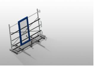
Rollenbahn vertikal für Transport von Fensterelementen. Stabile Stahlkonstruktion. Vertikale Rollenbahn für fließenden Transport zur nächsten Bearbeitung sowie auch für den Transport zur Lagerung und Sortierung der fertigen Fenster. Einfaches Handling von Fensterelementen. Jede Rollenbahneinheit 3.000 mm lang. Kunststoff-Gleitleisten oben und unten. Drei Röllchenbahnen mit Gummi-Rollen, Durchmesser 50 mm. Grundeinheit mit Endständer. Vertikale Rollenbahn auf Schienen mit Spurkranzrädern fahrbar.
