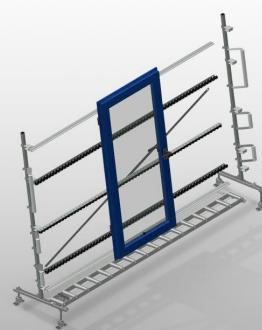
Rollenbahn vertikal für Transport und Lagerung von Fensterelementen. Stabile Stahlkonstruktion. Erweiterung im Baukastensystem. Vertikale Rollenbahn für fließenden Transport und Lagerung von Fensterelementen. Einfaches Handling von Fensterelementen. Jede Rollenbahneinheit 4.000 mm lang. Kunststoff-Gleitleisten oben und unten. Drei Röllchenbahnen mit Gummi-Rollen, Durchmesser 50 mm. Grundeinheit ohne Endständer.
