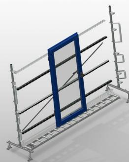
Rollenbahn vertikal für Transport und Lagerung von Fensterelementen. Stabile Stahlkonstruktion. Erweiterung im Baukastensystem. Vertikale Rollenbahn für fließenden Transport und Lagerung von Fensterelementen. Einfaches Handling von Fensterelementen. Jede Rollenbahneinheit 4.000 mm lang. Kunststoff-Gleitleisten oben und unten. Drei Röllchenbahnen mit Gummi-Rollen, Durchmesser 50 mm. Grundeinheit ohne Endständer.
