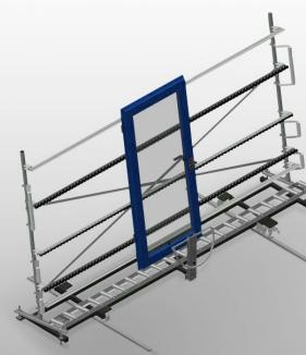
Stabile Stahlkonstruktion. Vertikale Rollenbahn für fließenden Transport zur nächsten Bearbeitung, sowie auch für den Transport zur Lagerung und Sortierung der fertigen Fenster. Einfaches Handling von Fensterelementen. Jede Rollenbahneinheit 4.000 mm lang. Kunststoff-Gleitleisten oben und unten. Drei Röllchenbahnen mit Gummi-Rollen, Durchmesser 50 mm. Grundeinheit mit Endständern. Vertikale Rollenbahn auf Schienen mit Spurkranzräder, fahrbar. Rollenbahn ist 360° drehbar.
