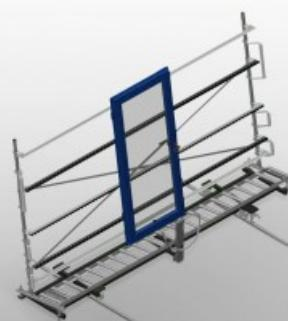
Stabile Stahlkonstruktion. Vertikale Rollenbahn für fließenden Transport zur nächsten Bearbeitung, sowie auch für den Transport zur Lagerung und Sortierung der fertigen Fenster. Einfaches Handling von Fensterelementen. Jede Rollenbahneinheit 4.000 mm lang. Kunststoff-Gleitleisten oben und unten. Drei Röllchenbahnen mit Gummi-Rollen, Durchmesser 50 mm. Grundeinheit mit Endständer. Vertikale Rollenbahn auf Schienen mit Spurkranzräder, fahrbar. Rollenbahn ist 360° drehbar.
