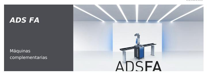
Unidad de atornillado con alimentación automática de los tornillos para la fijación del refuerzo en los perfiles de PVC. La sujeción y el atornillado se controlan mediante un mando bimanual. La unidad de atornillado está montada en una estructura metálica provista de transportadores de rodillos de entrada y salida.
