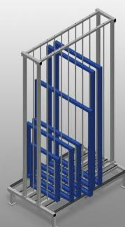
Estantería para el almacenamiento de elementos de ventana. Construcción estable de acero. Estantería para el almacenamiento de las hojas de las ventanas. Los elementos individuales están disponibles para el acceso directo. Especialmente diseñado para su integración en líneas de montaje. El acceso es posible desde ambos lados. Superficies de apoyo con rodillos de soporte para facilitar aún más la carga y descarga. Barras de separación de compartimentos cubiertas con tubos de protección.
