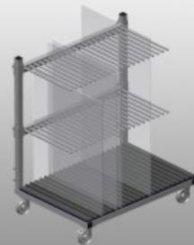
Carro de transporte de vidrio con estante de clasificación. Construcción estable de acero. Ideal para clasificar el vidrio. Superficie de apoyo de madera dura con fieltro. Separadores de compartimentos para 20 hojas de vidrio. La altura de los divisores de compartimentos es ajustable. Cuatro ruedas, dos de ellas con freno de fijación.
