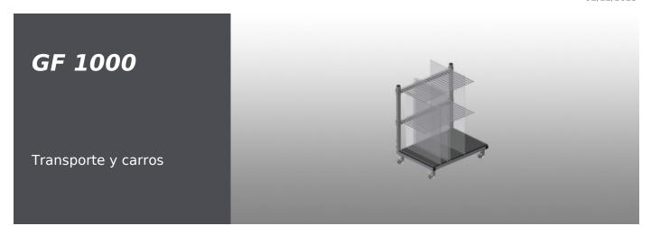
Carro de transporte de vidrio con estante de clasificación. Construcción estable de acero. Ideal para clasificar el vidrio. Superficie de apoyo de madera dura con fieltro. Separadores de compartimentos para 20 hojas de vidrio. La altura de los divisores de compartimentos es ajustable. Cuatro ruedas, dos de ellas con freno de fijación.
