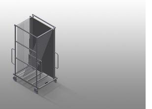
Construcción estable de acero. Clasificación de vidrio. Para el transporte interno de hojas de vidrio. Separadores de compartimentos para 15 hojas de vidrio. El acceso es posible desde ambos lados. La superficie de apoyo del vidrio tiene un perfil de goma. Separador de compartimentos con protector de plástico. Asa de transporte en ambos lados para la movilidad. Dos ruedas y dos rodillos fijos.
