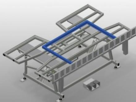
Mesa de montaje para el montaje vertical y horizontal. Construcción estable de acero. Importante cuando se pasa del transporte vertical al horizontal y viceversa. Ideal para el montaje vertical y horizontal. Inclinación neumática. Superficie de apoyo de la mesa con barras deslizantes de plástico. El soporte de rodillos se puede bajar neumáticamente. Suministro de aire comprimido cuádruple.
