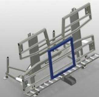
Mesa de montaje para el montaje vertical y horizontal. Construcción estable de acero. Importante cuando se pasa del transporte vertical al horizontal y viceversa. Ideal para el montaje vertical y horizontal. Inclinación neumática. Superficie de apoyo de la mesa con barras deslizantes de plástico. El soporte de rodillos se puede bajar neumáticamente. Suministro de aire comprimido cuádruple.
