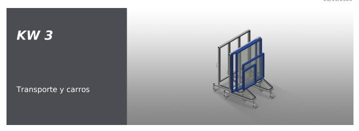
Carro de puesta en marcha para el transporte interno de elementos de ventana. Construcción estable de acero. Para el transporte interno. Soportes de perfil con superficie de goma. Se puede encajar cuando no está cargado - una característica que ahorra espacio. Cuatro ruedas, dos de ellas con freno de fijación.
