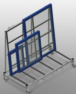
Carro de puesta en marcha para el transporte interno de elementos de ventana. Construcción estable de acero. Carro para el transporte interno. Aberturas para el transporte con carretilla elevadora. Cuatro bucles para el transporte con grúa. Cuatro puntos de fijación de la correa de amarre. Soportes de perfil con superficie de goma. Ruedas desmontables para aumentar la estabilidad del carro de puesta en marcha. Cuatro ruedas, dos de ellas con freno de fijación.
