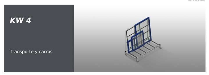
Carro de puesta en marcha para el transporte interno de elementos de ventana. Construcción estable de acero. Carro para el transporte interno. Aberturas para el transporte con carretilla elevadora. Cuatro bucles para el transporte con grúa. Cuatro puntos de fijación de la correa de amarre. Soportes de perfil con superficie de goma. Ruedas desmontables para aumentar la estabilidad del carro de puesta en marcha. Cuatro ruedas, dos de ellas con freno de fijación.
