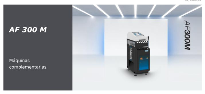
Fresadora retestadora horizontal con avance manual. Fresado fuera escuadra (+45°/90°/-45°). Cambio rápido del grupo de fresado con mando neumático. Plano de apoyo perfil antirrayas. Zona de mecanizado protegida integralmente.
