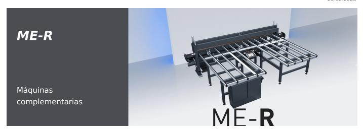
La ME-R es una máquina de corte semiautomática para marcos de PVC con dos ejes controlados. Está equipada con una unidad de corte CN con velocidad de avance ajustable.
