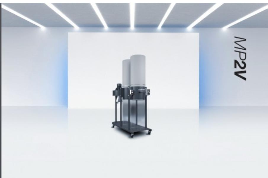
Sistema de aspiración de virutas de PVC en la unidad de trabajo, para tronzadoras mono cabezal. Aspirador silenciado de boca individual de aspiración idóneo también para el funcionamiento continuo. Ventilador de gran potencia con motor de 1,5 (kW). Sistema de recogida del material aspirado de bolsa individual de nylon de 180 litros, con sistema de desenganche rápido, para la eliminación simple y rápida del material aspirado.
