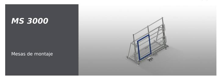
Mesa de montaje para el montaje vertical. Construcción estable de acero. Ideal para el montaje vertical. Adecuada para líneas. Posiciones intermedias infinitamente variables para un trabajo ergonómico. Ajuste de altura mediante cilindro neumático. Soporte con rodillos de acero. Superficie de apoyo de la mesa con barras de deslizamiento de plástico. Dos abrazaderas de perfil ajustables horizontalmente. Suministro de aire comprimido cuádruple.
