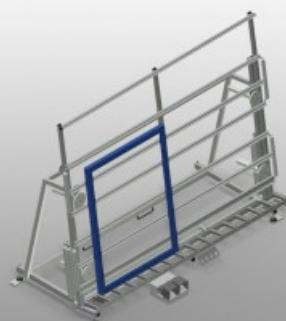
Mesa de montaje para el montaje vertical. Construcción estable de acero. Ideal para el montaje vertical. Adecuada para líneas. Posiciones intermedias infinitamente variables para un trabajo ergonómico. Ajuste de altura mediante cilindro neumático. Soporte con rodillos de acero. Superficie de apoyo de la mesa con barras de deslizamiento de plástico. Dos abrazaderas de perfil ajustables horizontalmente. Suministro de aire comprimido cuádruple.
