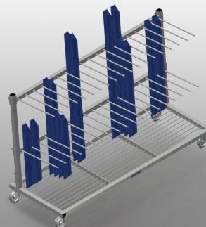
Carro de perfiles para el almacenamiento y transporte vertical de perfiles. Construcción estable de acero. Transporte vertical de perfiles. Carro de perfiles con carga en un lado. Fácil carga y descarga. Suficiente para 60 - 80 barras de perfil. La altura de los divisores de compartimentos es ajustable. Superficie de apoyo con suelo de rejilla para barras. Cuatro ruedas, dos de ellas con freno de fijación.
