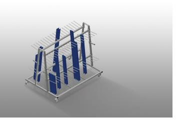
Carro de perfiles para el almacenamiento y transporte vertical de perfiles. Construcción estable de acero. Transporte vertical de perfiles. El carro de perfiles se puede cargar por ambos lados. 18 compartimentos por lado. Fácil carga y descarga. Suficiente para 120 - 160 barras de perfil. La altura de los separadores de los compartimentos es ajustable. Superficie de apoyo con suelo de rejilla para barras. Cuatro ruedas, dos de ellas con freno de fijación.
