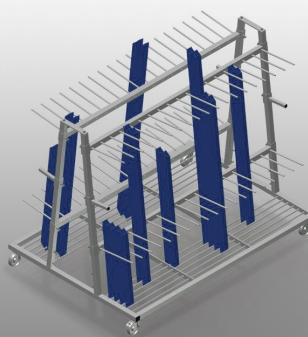
Carro de perfiles para el almacenamiento y transporte vertical de perfiles. Construcción estable de acero. Transporte vertical de perfiles. El carro de perfiles se puede cargar por ambos lados. 18 compartimentos por lado. Fácil carga y descarga. Suficiente para 120 - 160 barras de perfil. La altura de los separadores de los compartimentos es ajustable. Superficie de apoyo con suelo de rejilla para barras. Cuatro ruedas, dos de ellas con freno de fijación.
