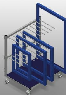
Carro de perfiles para el transporte interno de marcos y hojas. Construcción estable de acero. Carro con estante de clasificación para el transporte y almacenamiento de marcos y hojas. Superficie de apoyo de madera dura. Separadores de compartimentos para nueve marcos. La altura de los divisores de compartimentos es ajustable. Cuatro ruedas, dos de ellas con freno de fijación.
