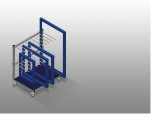
Carro de perfiles para el transporte interno de marcos y hojas. Construcción estable de acero. Carro con estante de clasificación para el transporte y almacenamiento de marcos y hojas. Superficie de apoyo de madera dura. Separadores de compartimentos para nueve marcos. La altura de los divisores de compartimentos es ajustable. Cuatro ruedas, dos de ellas con freno de fijación.
