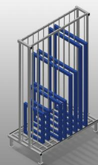
Estantería para el almacenamiento de los elementos del bastidor. Construcción estable de acero. Estantería para el almacenamiento de bastidores. Los elementos individuales están disponibles para el acceso directo. Especialmente diseñado para su integración en líneas de montaje. El acceso es posible desde ambos lados. Soporte de suelo equipado con perfil de pomo. Barras de separación de compartimentos cubiertas con tubos de protección.
