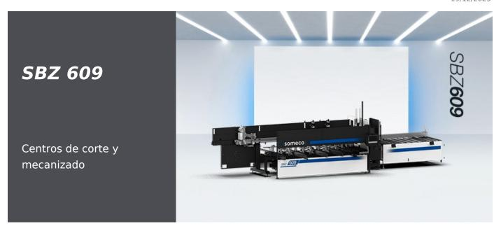
Centro de mecanizado para atornillar refuerzo, taladrar y fresar perfiles precortados para la fabricación de ventanas y puertas con y sin armazón de acero. Realizado en versión portal para secciones de perfiles grandes y para procesos optimizados. Aumento de la eficiencia mediante la elaboración paralela del atornillador para refuerzos externos.
