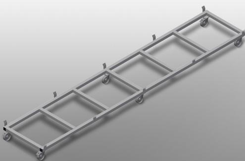
Construcción estable de acero. Carro de transporte para transportar cassetes de perfiles. Ideal para transportar cassetes de perfiles del almacén a la sierra o al centro de mecanizado. Para paletas de perfiles de hasta 760 mm de ancho. Pestañas de seguridad para asegurar los palets. Seis rodillos, cuatro ruedas con frenos de fijación y dos rodillos fijos.
