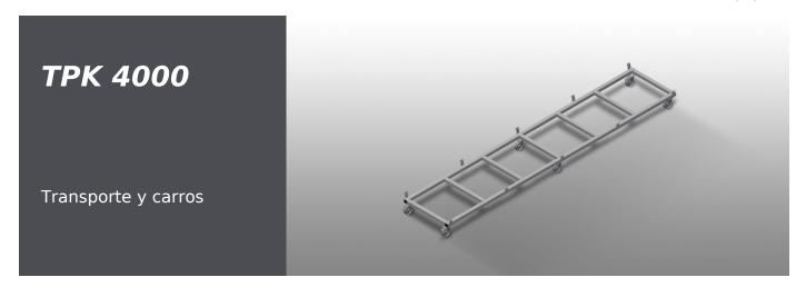
Construcción estable de acero. Carro de transporte para transportar casetes de perfiles. Ideal para transportar casetes de perfiles del almacén a la sierra o al centro de mecanizado. Para paletas de perfiles de hasta 760 mm de ancho. Pestañas de seguridad para asegurar los palets. Seis rodillos, cuatro ruedas con frenos de fijación y dos rodillos fijos.
