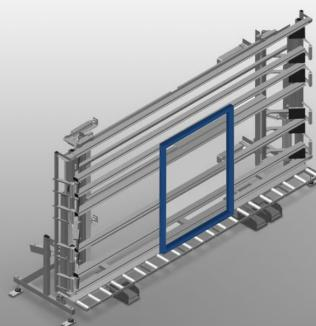
Unidad de control y de acristalamiento para acristalar y hacer el control final en la fabricación individual y en serie. Montaje rápido y exacto de ventanas, puertas y elementos. Exactitud gracias al prensado paralelo de traviesa. Estable construcción en acero. Ajuste continuo de la altura. Fácil manipulación por comutador de pedal. Dos traviesas de prensa neumáticamente abatibles y móviles y cuádruple toma de aire comprimido.
