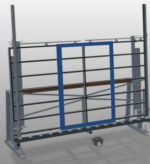
Unidad de control y de acristalamiento para acristalar y hacer el control final. Montaje rápido y exacto de ventanas, puertas y elementos. Estable construcción en acero. Exactitud gracias al prensado paralelo de traviesa con traviesas de prensa manualmente orientables. Fácil manipulación por conmutador de pedal. Centraje neumático, bandeja para herramienta y cuádruple toma de aire comprimido.
