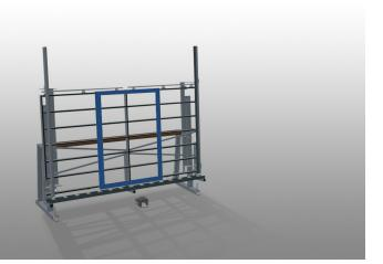
Unidad de control y de acristalamiento para acristalar y hacer el control final. Montaje rápido y exacto de ventanas, puertas y elementos. Estable construcción en acero. Exactitud gracias al prensado paralelo de traviesa con traviesas de prensa manualmente orientables. Fácil manipulación por conmutador de pedal. Centraje neumático, bandeja para herramienta y cuádruple toma de aire comprimido.
