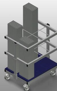
Chariot de transport et de mise à disposition avec triage des renforts métalliques. Construction en acier stable. Stockage et transport verticaux des profilés en acier. Dimensions extérieures réduites. Disposition claire du profilé pour les longueurs fixes. 4 roulettes de direction, dont 2 à frein de blocage.
