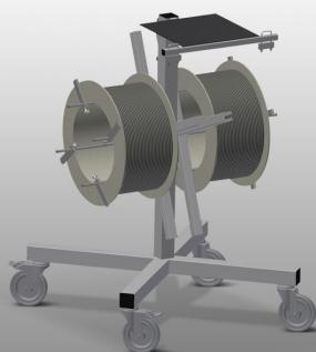
Chariot à joints pour la réception des rouleaux de joints. Construction en acier stable. Logement pour 2 bobines. Indispensable lors de la mise en place du joint. Possibilité de réglage pour chaque diamètre de bobine. Emplacement de rangement des outils. 4 roulettes de direction, dont 2 à frein de blocage.
